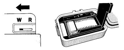
フイルム室蓋をしっかり閉じ、シャッターレバーを何度か押して、フイルムカウンター(3)に目盛り「I」が出るまで続けて下さい。
